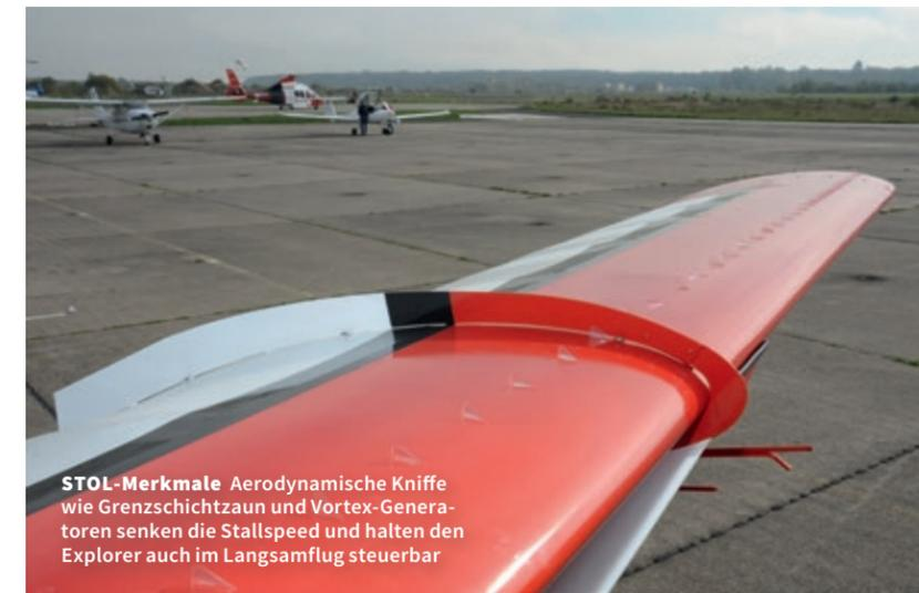
**STOL-Merkmale** Aerodynamische Kniffe wie Grenzschichtzaun und Vortex-Generatoren senken die Stallspeed und halten den Explorer auch im Langsamflug steuerbar
